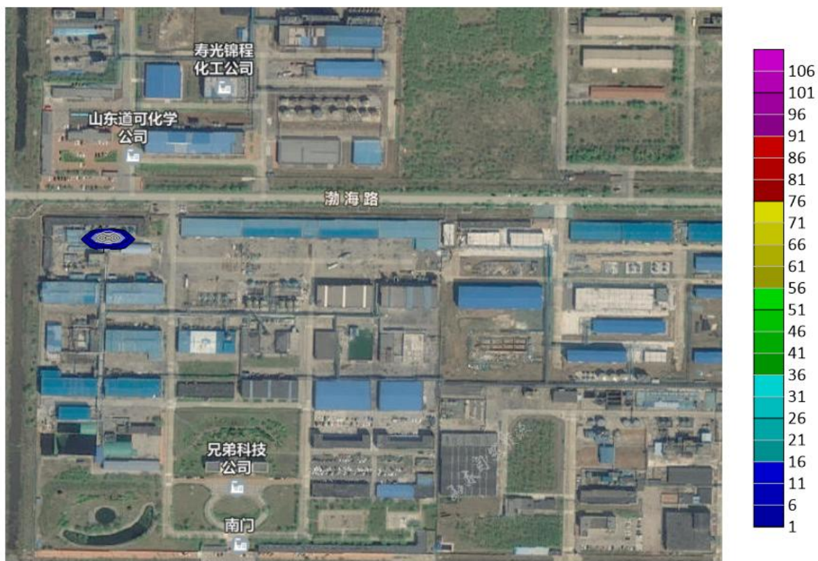
图 4.3.3-10 长期泄漏 100d，氨氮在地下水中污染范围示意图
