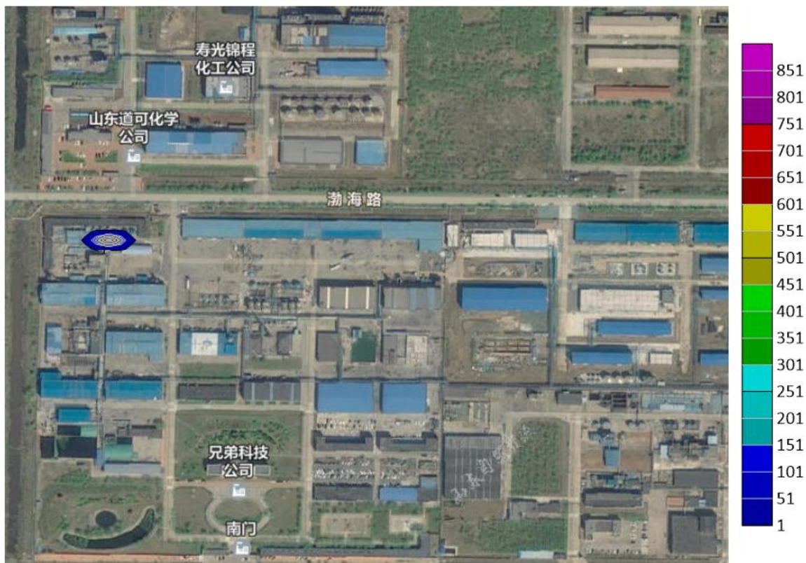
图 4.3.3-7 长期泄漏 100d, COD 在地下水中污染范围示意图
