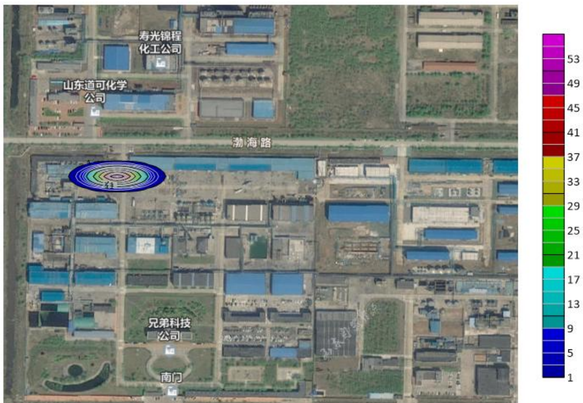
图 4.3.3-2 短期泄漏 1000d, COD 在地下水中污染范围示意图
