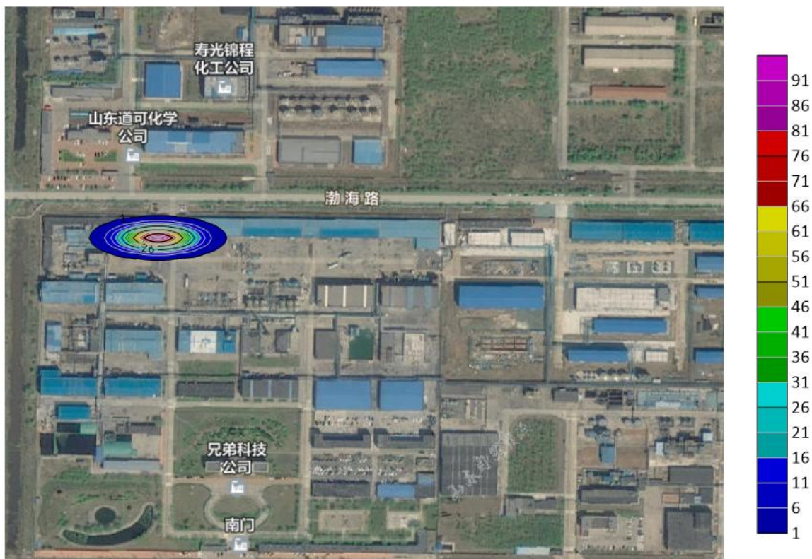
图 4.3.3-8 长期泄漏 1000d, COD 在地下水中污染范围示意图
