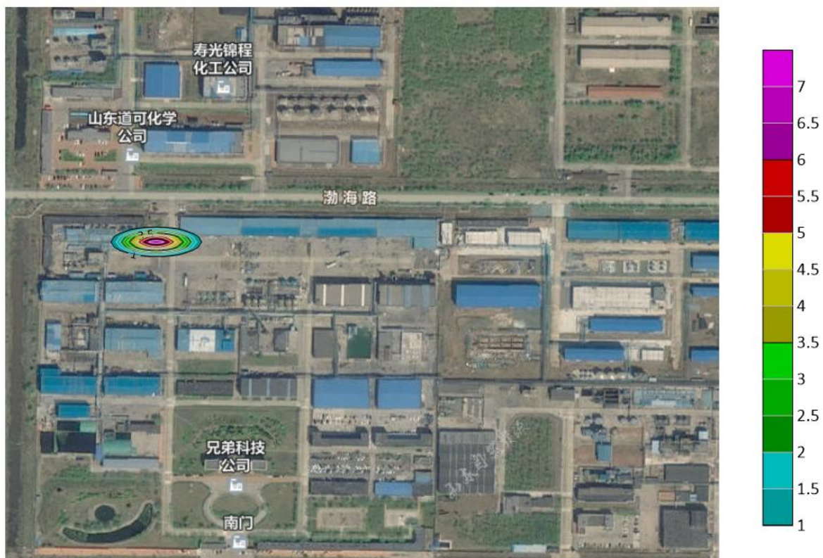
图 4.3.3-5 短期泄漏 1000d，氨氮在地下水中污染范围示意图
