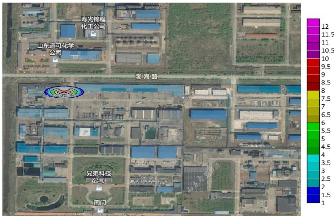
图 4.3.3-11 长期泄漏 1000d，氨氮在地下水中污染范围示意图
