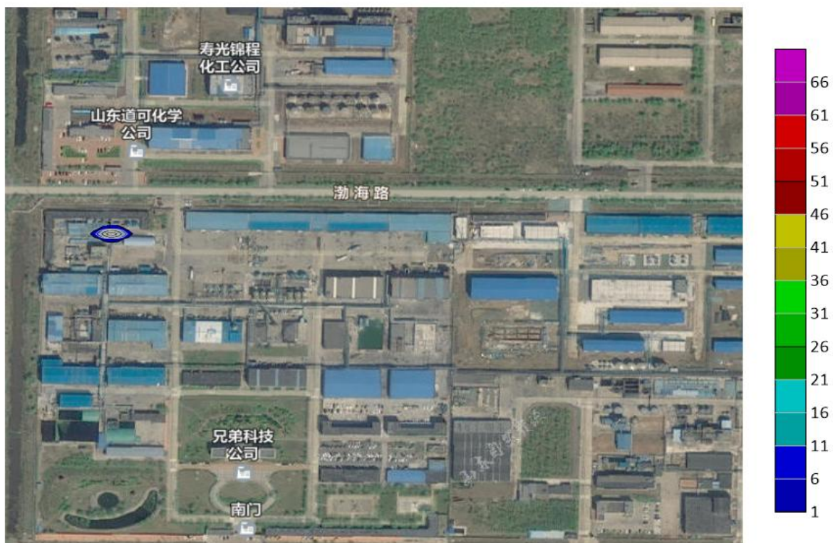
图 4.3.3-4 短期泄漏 100d，氨氮在地下水中污染范围示意图
